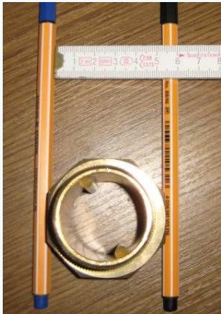
Abb. 4: Stiftmethode — zwei Stifte an das Rohr anlegen (blaue Pfeile)
