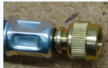
Abb. 5c: Anschluss zum Schrauben an das Ausdehnungsgefäß
