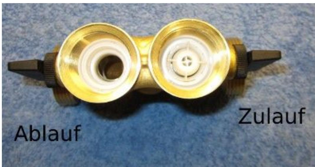
Unterhalb des Verschlussstopfen des Zulauf befindet sich der Rückschlageinsatz
