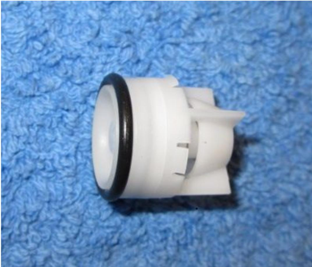
Vor dem Einführen des neuen Rückschlageinsatzes den O-Ring auf diesen aussetzen.
