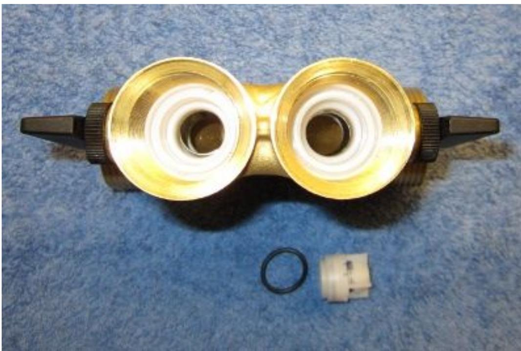
wichtig beim Entfernen des Rückschlageinsatzes ist, dass wir den O-Ring mit herausnehmen.
