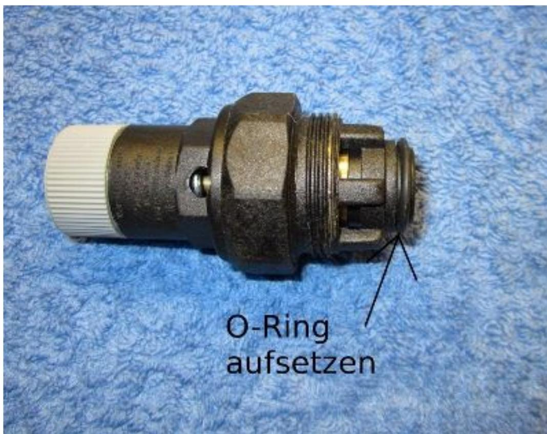
Vor Montage des neuen Sicherheitsventils ist zu prüfen dass der O-Ring auf diesem gut sitzt.
