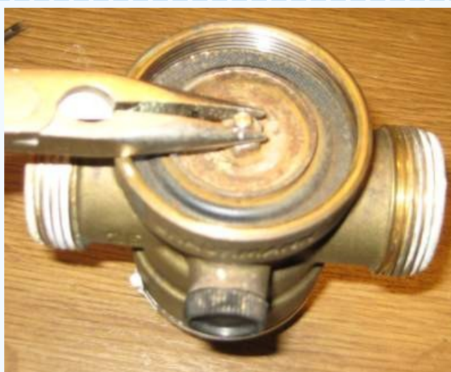
Abb. 4: alten Ventileinsatz herausziehen
