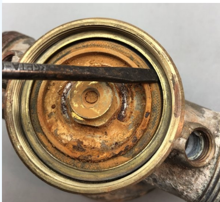
Abb 1: Gleitring mit Schraubendreher vorsichtig lösen
