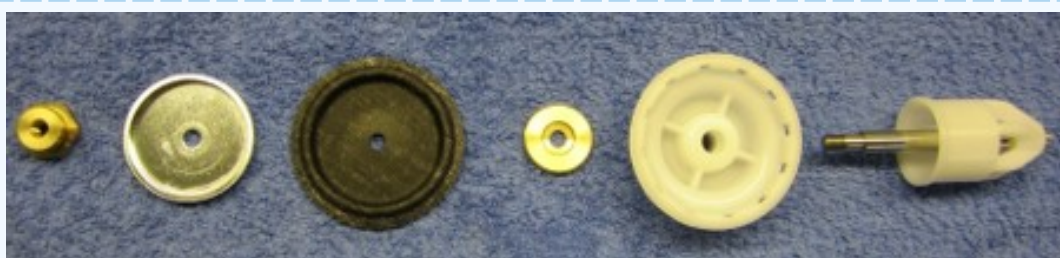
Abb. 9: Einzelteile des Ventileinsatzes
