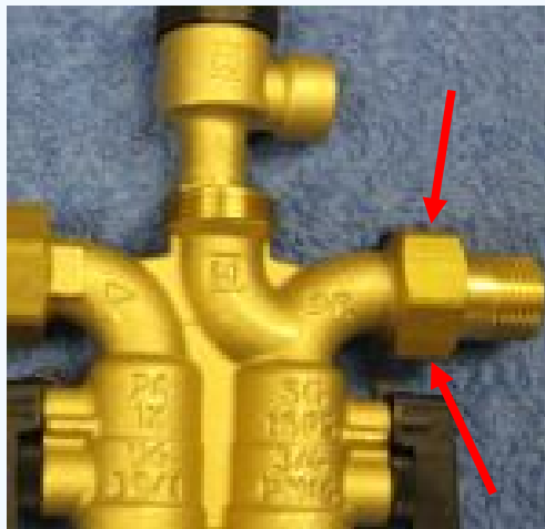
Abb. 2: Messung direkt an der Überwurfmutter
