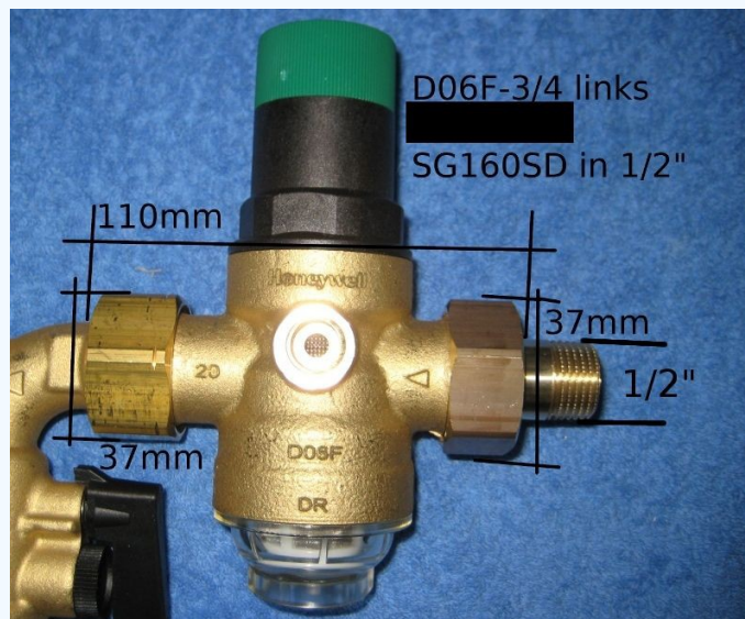
Abb. 5: D06F-3/4-Links – Baulänge 110 mm, Überwurfmuttern SW 37 mm, Ausgang 1/2"
