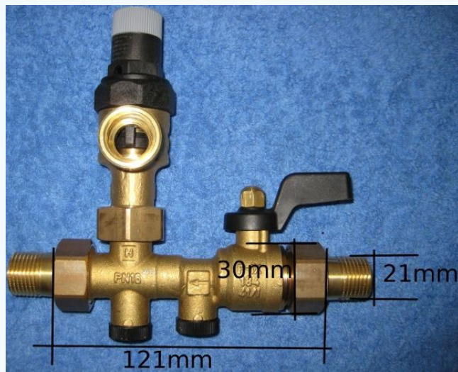
Abb. 8: SG150 in 1/2" – Baulänge 121 mm, SW 30 mm, Anschluss 21 mm
