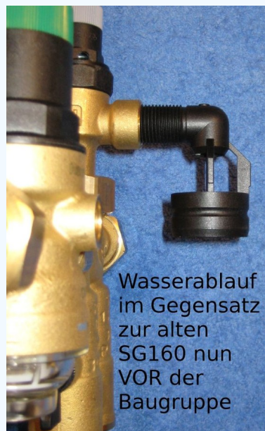
Abb. 13: Wasserablauf jetzt vor der Baugruppe
