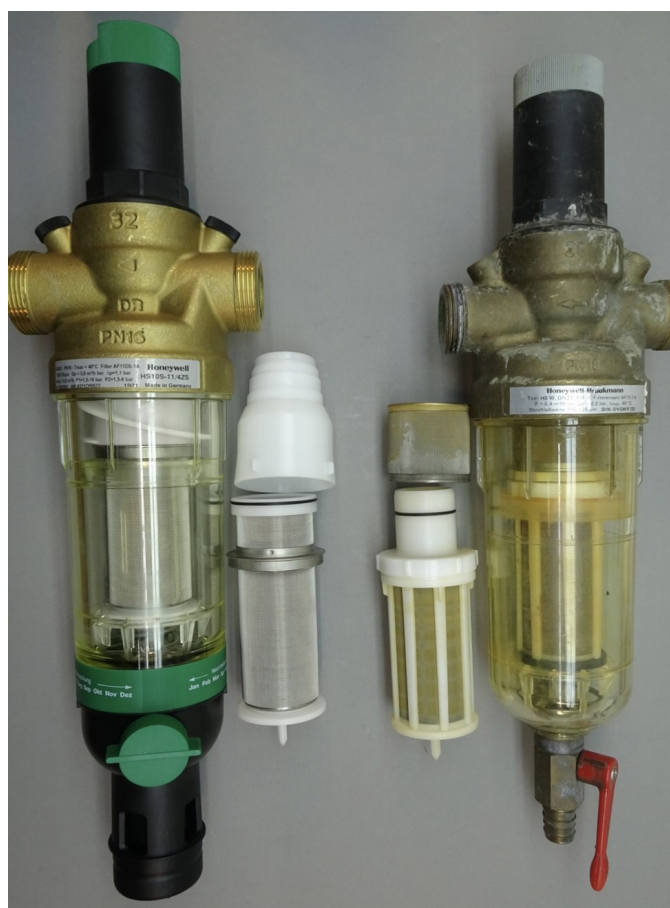
Abb. 1: Direktvergleich HS10S (links, aktuell) mit AF11DS-1A und HS10 (rechts, alte Baureihe) mit AF11-1A. Erkennbar: HS10S hat grünen Federhaubenkopf und Klarsicht-Filtertasse; HS10 hat grauen Kopf und gelblich verfärbte Tasse. Die Filtereinsätze sind nicht untereinander kompatibel.
