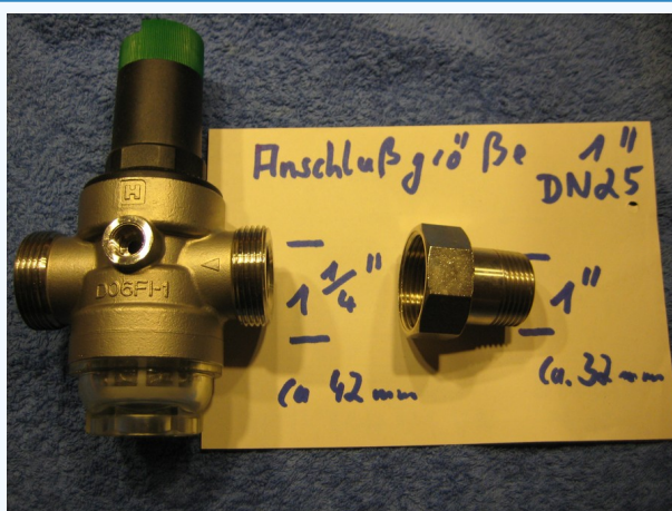
Abb. 1: Anschlussgröße = Gewinde der Anschlussverschraubung (hier 1" / DN25); Gewinde am Druckminderer immer eine Nenngröße größer
